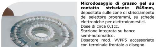
**Microdosaggio di grasso gel su contatto strisciante Ø45mm**, depositato sulle zone di strisciamento del selettore programmi, su schede elettroniche per elettrodomestici. Dose di circa 0,1cc. Stazione integrata su banco semi-automatico. Dosatore mod. VVPP5 accessorizzato con terminale frontale a disegno.
