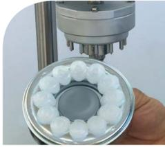
**Dosaggio di grasso siliconico ad alta consistenza**. Dosaggio di 20cc di grasso in un unico ciclo automatico tramite dosatore VVAP30, distribuiti in una corona frontale tramite un terminale realizzato a disegno.
