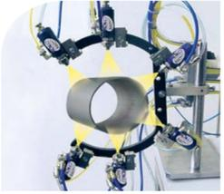
**Applicazione di valvole VMJETE per microspruzzatura di protettivo antiruggine su tubi.**
