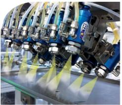
**Applicazione di batteria di valvole VMJETC per la microspruzzatura di lubrificante all'interno di fori su bancale di motore.**
