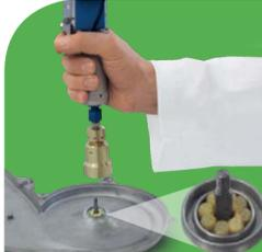
**Microdosaggio di grasso all'interno della cava circolare Ø12mm**. Dosaggio di circa 0,8cc depositati su una corona frontale tramite terminale speciale multicanale. Dosatore impugnato con controllo e certificazione della dose tramite sensore di flusso TM VSF.
