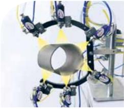
**Applicazione di valvole VMJETE** per microspruzzatura di protettivo antiruggine su tubi.
