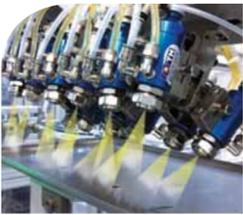
**Applicazione di batteria di valvole VMJETC** per la microspruzzatura di lubrificante all'interno di fori su bancale di motore.
