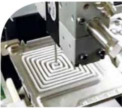
**Cordolo di thermal grease** (pasta termococonduttiva) **fortemente caricato**. Erogazione di 6cc in circa 15s con distribuzione in una spirale quadrata. Applicazione realizzata con testa speciale DVL per fluidi abrasivi, con realizzazione di una unità M-ONO con pompa a piatto premente speciale per fluidi abrasivi.
