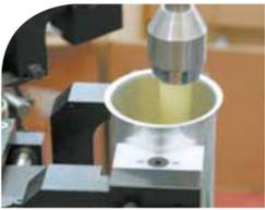
**Riempimento di un condensatore con olio**, tramite dosatore VVAP100.
