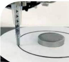
**Microcordolo di resina epossidica bicomponente** rapporto 1:3 con erogazione complessiva di circa 0,10g in 5s lungo una **circonferenza Ø70mm**. Applicazione realizzata tramite gruppo dosatore mod. DVL2 con alimentazione tramite pompe serie PE25.
