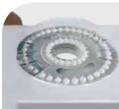
**Microdosaggio di grasso gel su contatto strisciante Ø45mm**, depositato sulle zone di strisciamento del selettore programmi, su schede elettroniche per elettrodomestici. Dose di circa 0,1cc. Stazione integrata su banco semi-automatico. Dosatore mod. VVPP5 accessorizzato con terminale frontale a disegno.
