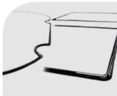
**Esempi di cordoli e microcordoli volumetrici di siliconi monocomponente per sigillatura e guarnizioni liquide**. Applicazioni realizzate con gruppi dosatori mod. DVC per siliconi con alimentazione tramite pompe serie PE25 o estrusori per cartuccia serie SBE.
