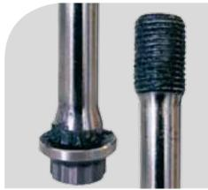
**Microdosaggio di pasta base bisolfuro di molibdeno e grafite** su sottotesta e filetto di viti di biella per motori a scoppio settore automotive e corse. Dose di circa 0,3cc. Stazione manuale. N.3 dosatori mod. VVPP5 accessorizzati con sensori di flusso analogici per certificazione passaggio prodotto e processo, con terminale speciale radiale multizona auto-adattivo per gestire viti di lunghezza diversa.
