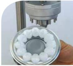
**Dosaggio di grasso silconico ad alta consistenza**. Dosaggio di 20cc di grasso in un unico ciclo automatico tramite dosatore VVAP30, distribuiti in una corona frontale tramite un terminale realizzato a disegno.
