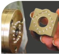
**Microdosaggio di grasso fluorurato lungo sede perimetrale di 1mm** per trattenere una guarnizione durante le fasi di montaggio di una valvola pneumatica per macchine tessili. Dose di circa 0,02cc. Stazione manuale. Dosatore mod. VVPP3 accessorizzato con terminale frontale a disegno.
