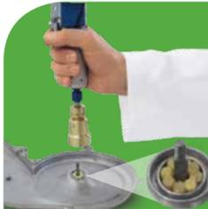
**Microdosaggio di grasso all'interno della cava circolare Ø12mm**. Dosaggio di circa 0,8cc depositati su una corona frontale tramite terminale speciale multicanale. Dosatore impugnato con controllo e certificazione della dose tramite sensore di flusso TM VSF.
