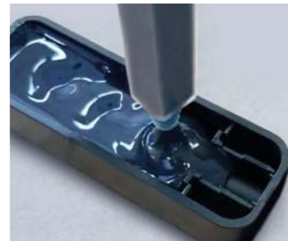
Potting circuiti elettronici.
