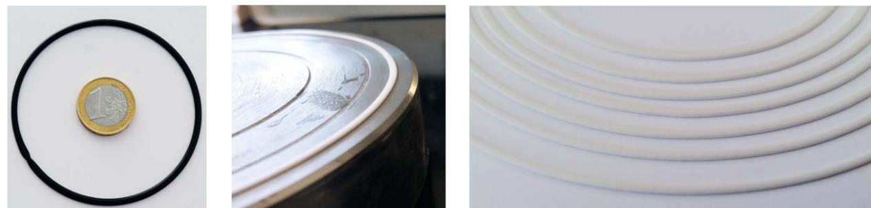
Esempi di cordoli eseguiti con dosatori volumetrici progressivi **VVPR**, azionati da camme.
